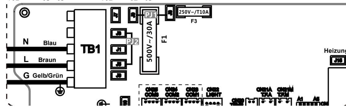
Eingangsspannung: 220 – 240 V AC, 50/60 Hz, 2P x 16 A
