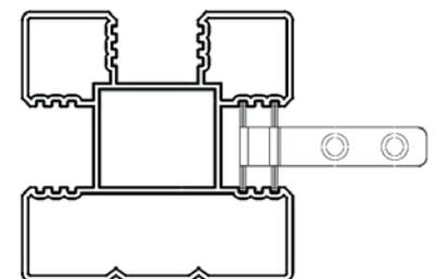
Setzen Sie zum Abschluss die Pfostenkappe vorsichtig auf die Pfosten. (Keinen Hammer oder ähnliche Schlagwerkzeuge benutzen)
