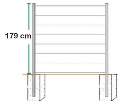
Der Pfosten kann mit einer geeigneten Kappsäge auf die benötigte Länge gekürzt werden.
