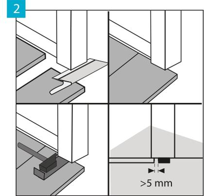
Dilatationen entlang den Wänden sollen mit passenden anhand von Klebstoff oder Klips montierten Sockelleisten zugedeckt werden. Wir empfehlen unsere Sockelleisten von Arbiton, die zu einzelnen Designbodendekoren passen und stoß- und kratzbeständig sind.
