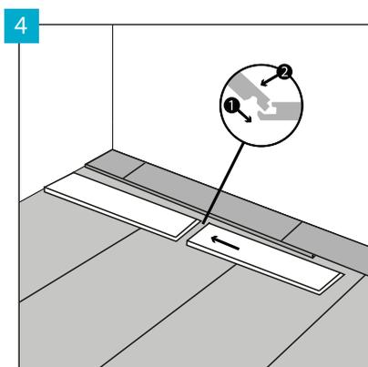
Die Arbiton-Bodenpaneele werden mit den Verschlüssen, die auf der kurzen und der langen Kante zu verbinden sind, versehen. Zuerst müssen die kurzen Kanten der Paneele miteinander verbunden werden.
