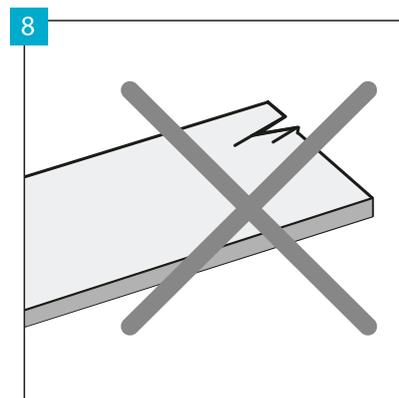
Vor und während der Verlegung sind sämtliche Platten bei Tageslicht eingehend auf Beschädigungen und Materialfehler zu überprüfen. Platten mit sichtbaren Mängeln oder Beschädigungen dürfen nicht verlegt werden.
