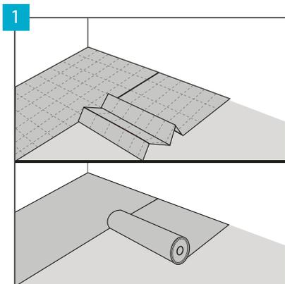
Verlegen Sie die Arbiton-Unterlage: Multiprotec LVT oder Secura LVT Click Smart N quer zur Verlegerichtung der Paneele. Legen Sie die Nebenbahnen bündig aneinander an, lassen Sie sie überlappen oder verbinden Sie sie mit Klebeband Arbiton AluTape. Vermeiden Sie Abstände.
