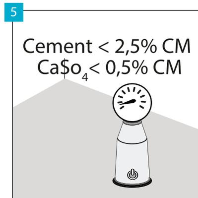
Beim Zementausgleich darf die Feuchtigkeit des Unterbodens 2,5% nicht überschreiten, und bei Anhydritmassen 1,5%. Bei der Verlegung über der Bodenheizung betragen die erforderlichen Werte jeweils 1,5% und 0,3%.
