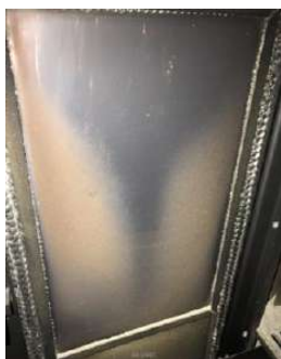
Beispiel einer verschmutzten Scheibe
