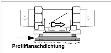
Abb. 3: Einbaudrehflansch
