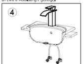
4. Drehen Sie nach der Installation die Wasserverteiler auf, um zu überprüfen, ob es Leckagen gibt. Heben Sie den Hahngriff nach oben und unten, um das Wasser ein- und auszustellen. Drehen Sie den Griff nach links und rechts, um die Wassertemperatur einzustellen. Lassen Sie das Wasser bei der ersten Verwendung mindestens 15 Sekunden lang eingeschaltet, um das Rohr zu reinigen (wie in Abbildung 4 gezeigt).
