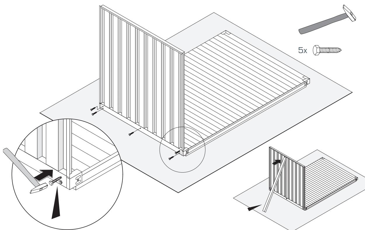
**TIPP!** Für leichteres Einschlagen der Schrauben die Löcher ( $\varnothing$  5 mm) vorbohren.
