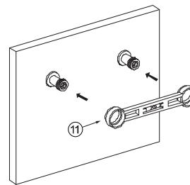
c) Vergewissern Sie sich, dass die 2 gebogenen Anschlüsse genau gerade in die Wand eingebaut sind. Der Achsabstand zwischen 2 gebogenen Anschlüssen beträgt 150±8mm. Verwenden Sie die Wasserwaage **11**, um sicherzustellen, dass die Mittellinie horizontal bleibt .
