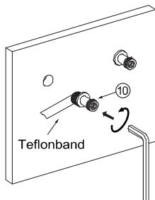
b) Wickeln Sie das Teflonband gegen den Uhrzeigersinn auf das Gewinde des G1/2-Endes des gebogenen Anschlusses **10**, verbinden Sie sie mit den Warm- und Kaltwasserauslässen mit einem Schraubenschlüssel. Lassen Sie eine angemessene Tiefe aus der Wand heraus und stellen Sie den Abstand zwischen den 2 Anschlüssen entsprechend der Breite des Einlasses an der Thermostat-Duschstange ein .
