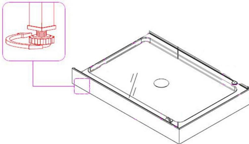
Die Abflüsse des Rahmens müssen mit in den Bodenabfluss eingeführt werden.
