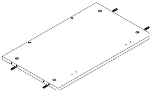
**Schritt 3: Verbindungsbeschlag eindrehen, Rückwand befestigen**
