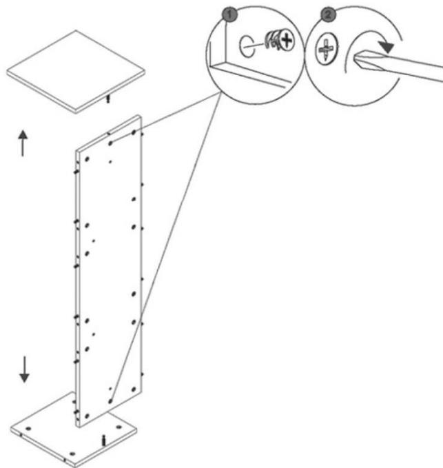
**Schritt 4: Verbindungsbeschlag eindrehen, Seitenwände befestigen**
