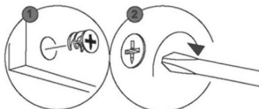
**Schritt 4: Verbindungsbeschlag eindrehen, Unterschrank zusammensetzen**
