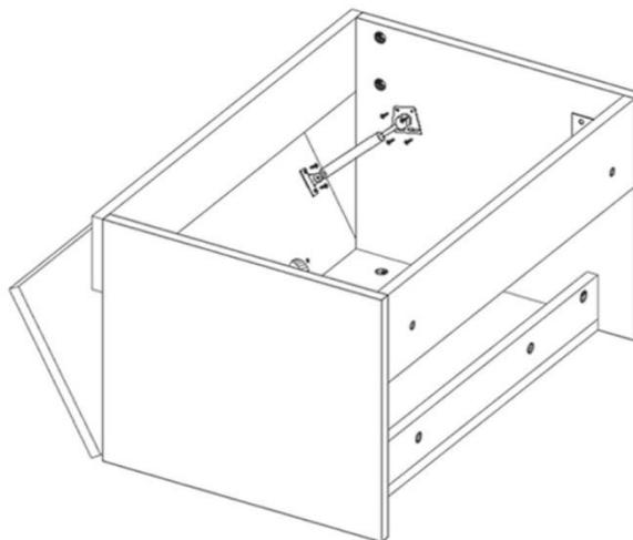
**Schritt 8: Unterschrank an der Wand installieren**
