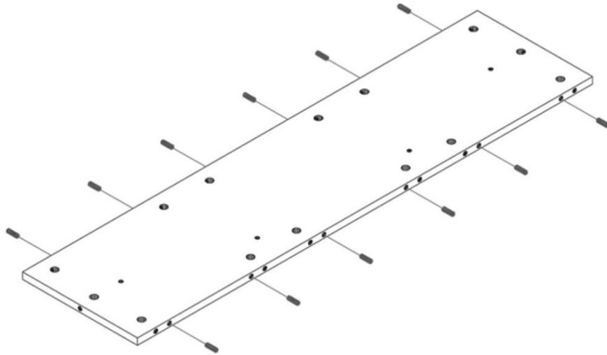
**Schritt 3: Verbindungsbeschlag eindrehen, Rückwand befestigen**
