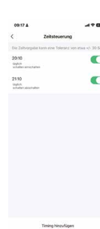
18. Beachten Sie, dass ein Zeitplan nur das Ein- oder Ausschalten des Handtuchhalters steuern kann. Um automatische Ein- und Ausschalvorgänge zu ermöglichen, müssen zwei separate Zeitpläne erstellt werden.
