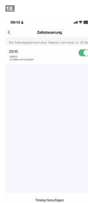
18. Beachten Sie, dass ein Zeitplan nur das Ein- oder Ausschalten des Handtuchhalters steuern kann. Um automatische Ein- und Ausschalvorgänge zu ermöglichen, müssen zwei separate Zeitpläne erstellt werden.
