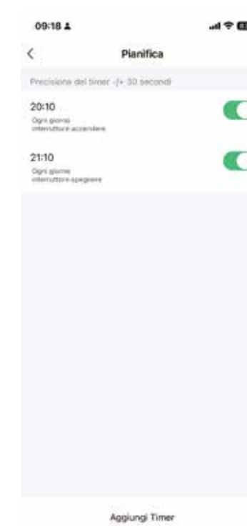
18. Una programmazione supporta solo l'apertura o la chiusura del portasciugamani elettrico; se si desidera che si apra e si chiuda automaticamente, è necessario impostare due programmazioni per realizzare questa funzione.
