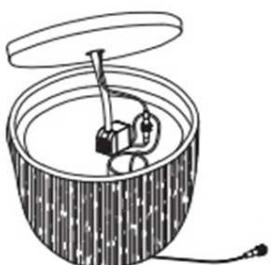
2. Koble pumpens ledning til transformatoren. Koble deretter transformatoren til en jordet stikkontakt.
