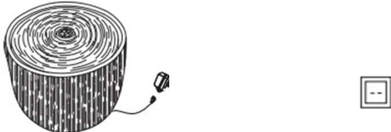
3. Riempire la fontana con una quantità di acqua pulita sufficiente a mantenere la pompa completamente sommersa durante il funzionamento.
