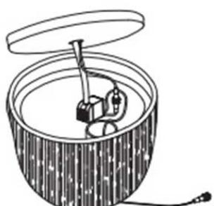
2. Collegare il cavo della pompa al trasformatore. Quindi, collegare il trasformatore a una presa elettrica con messa a terra.
