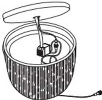
2. Tilslut pumpens ledning til transformeren. Sæt derefter transformeren i en stikkontakt med jordforbindelse.
