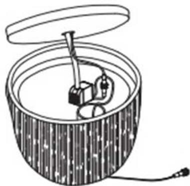
1. Sluit het pompsnoer aan op de transformator. Steek vervolgens de transformator in een geaard stopcontact.
