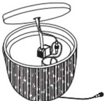
2. Ligue o cabo da bomba ao transformador. Em seguida, ligue o transformador a uma tomada elétrica com ligação à terra.
