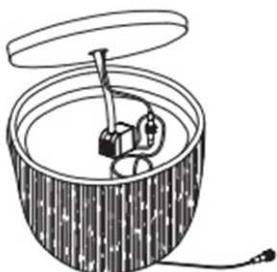
2. Conectați cablul pompei la transformator, apoi conectați transformatorul la o priză împământată corespunzător.
