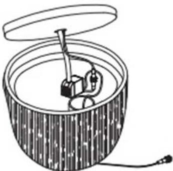
2. Csatlakoztassa a szivattyú kábelét a tápegységhez. Ezután csatlakoztassa a tápegységet egy földelt konnektorba.
