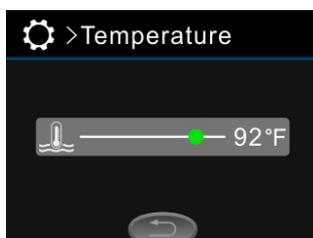
Mit der Temperatur Einstellung kann die Wassertemperatur festgelegt werden. Die Wassertemperatur kann zwischen 10°C - 40°C eingestellt werden, dieses erfolgt mit den Navigationstasten „Links“ und „Rechts“. Die ausgewählte Wassertemperatur ist festgelegt, sobald das Menü verlassen wird. Ist die Wassertemperatur niedriger, beginnt die Heizung automatisch zu heizen.
