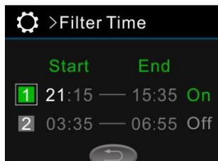
Die Zeiteinstellung der Filterreinigung funktioniert nach dem gleichen Prinzip, wie die Zeiteinstellung der Heizfunktion. Wechsel vom Filter des Produkts (siehe Montageanleitung, Hinweise zur Pflege und Reinigung).
