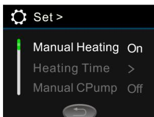
Die Heizung kann im Display ein- bzw. ausgeschaltet werden.
