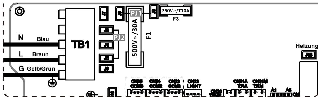
Eingangsspannung: 220 – 240 V AC, 50/60 Hz, 2P x 16 A
