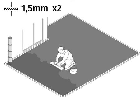
Für eine fertige Gummihaut von 2-3 mm Dicke 2 - 3 Schichten nass auftragen.
