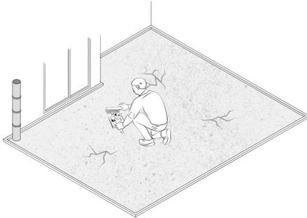
Der Untergrund muss sauber, trocken und frei von Öl, Staub und losen Teilen sein.
