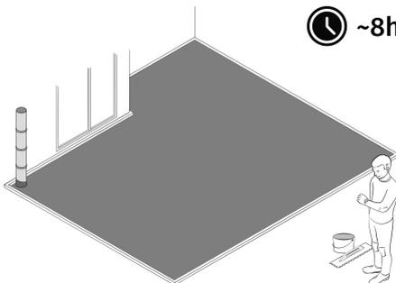
ALLESDICHT wird in 2 bis 3 Schichten nass auf trocken aufgetragen.
