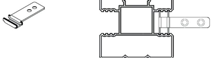
Setzen Sie zum Abschluss die Pfostenkappe vorsichtig auf die Pfosten. (Keinen Hammer oder ähnliche Schlagwerkzeuge benutzen)
