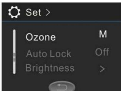
Die Ozon-Reinigung kann auf automatisch oder manuell eingestellt werden. Wähle mit den Navigationstasten in „Einstellungen“ (Set) das Ozon-Menü. Um zwischen der automatischen oder manuellen Ozonreinigung zu wechseln, bestätige den Unterpunkt „Ozone“. Das „M“ auf der rechten Seite steht für Manuell. Im Auto-Modus ist ein vom Werk festgelegtes Programm gespeichert.
