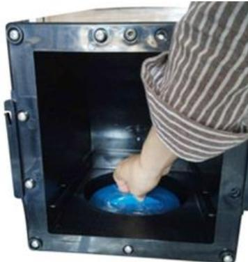
Setze das Gitter auf die Filterkartusche und die Abdeckung wieder ein, anschließend muss diese wieder verschraubt werden.
