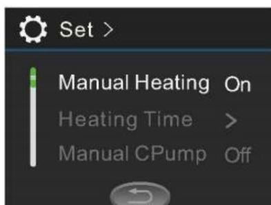
Wenn Du durch das Menü auf die Heizfunktion gelangst, kann diese mit der Bestätigungstaste aktiviert werden (Manual Heating  ON/OFF). Sobald diese gestartet wird, leuchtet ein entsprechendes Symbol im Startbildschirm auf. Nach dem Abschalten wird dieses nicht mehr angezeigt.
