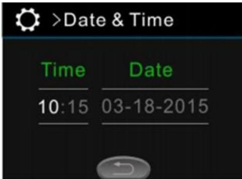
Die Zeit Einstellung ist sehr wichtig für das Kontrollsystem, an dieser orientieren sich alle Zeit Funktionen (z.B. die Heizung und die Zirkulationspumpe). Wähle in „Einstellungen“ (SET) das Datum und Zeit Einstellung (Date & Time). Mit der „Bestätigen“ Taste wird zwischen Uhrzeit und Datum gewechselt. Die Uhrzeit und das Datum werden mit der „links“ und „rechts“ Taste eingestellt. Die Einstellung wird angenommen, sobald das Menü verlassen wird.
