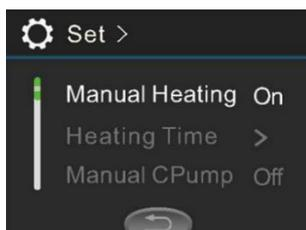
Die Heizung kann im Display ein- bzw. ausgeschaltet werden.
