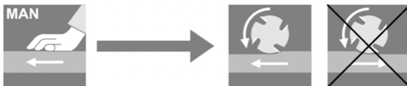
MAN (Handvorschub) Gleichlauf: Verboten wegen Rückschlaggefahr
