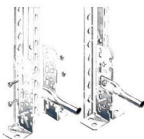
... und die rückseitige Diagonale einklopfen, so dass ein Kreuz entsteht.
