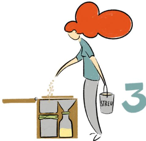
3 Gib nach dem großen Geschäft bitte genügend Streu in den Feststoffbehälter, damit alles bedeckt ist. Den vorderen Teil des Trenneinsatzes kannst du mit einigen Sprühstößen mildem Reiniger ausspülen.
