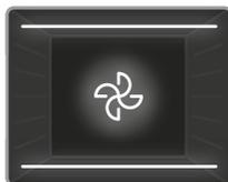
**Umluft-Funktion:** Das Backofenthermostat und die Warnleuchten werden eingeschaltet, und die Heizelemente für Ober- und
