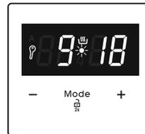
3. Nach einigen Sekunden hört der Punkt auf zu blinken und wird dauerhaft angezeigt.
