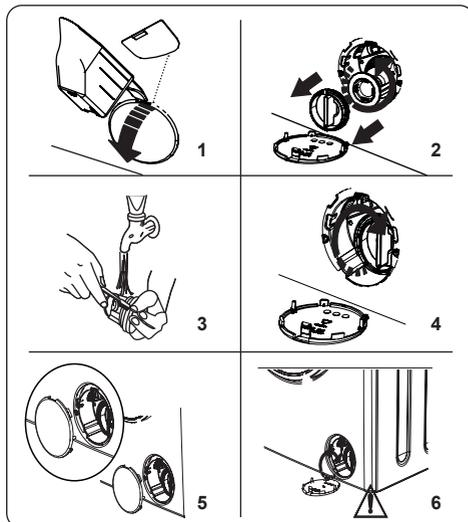
Das Pumpenfiltersystem in Ihrer Waschmaschine verlängert die Lebensdauer der Pumpe, indem es verhindert, dass Fusseln in Ihr Gerät gelangen.
