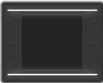
**Ober- und Unterhitze:** Das Backofenthermostat und die Warnleuchten werden eingeschaltet, und die Heizelemente für Ober- und
