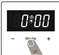
1. Drücken Sie "MODE" für 2 Sekunden, um die Tastensperre zu deaktivieren, und der Punkt in der Mitte des Bildschirms beginnt zu blinken.
