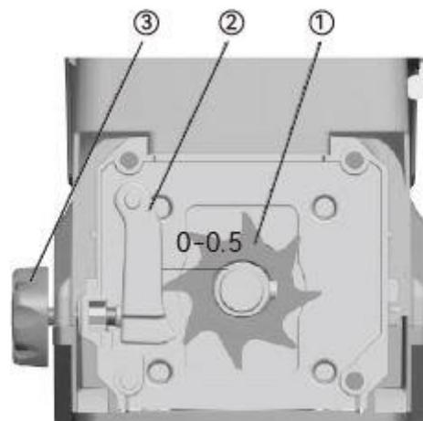
**⚠ ACHTUNG** Falls das Häckselmesser die Messerwalze, wird dieses nachgeschnitten und kleine Metallspäne können aus der Auswurföffnung fallen. Dies ist kein Fehler, jedoch darf nur im erforderlichen Maß nachjustiert werden, da sonst das Gegenmesser vorzeitig verschleißt. Wenn das Gegenmesser nicht mehr weiterrachgestellt werden kann hat es seine Verschleißgrenze erreicht und muss ausgetauscht werden.
