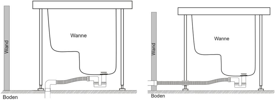
Der Abfluss befindet sich im Boden, der Abwasserschlauch kann jedoch auch an einem Abfluss in der Wand angebracht werden, jedoch nicht höher als 6 cm zur Lochmitte, damit der Ablauf noch gewährt ist.
