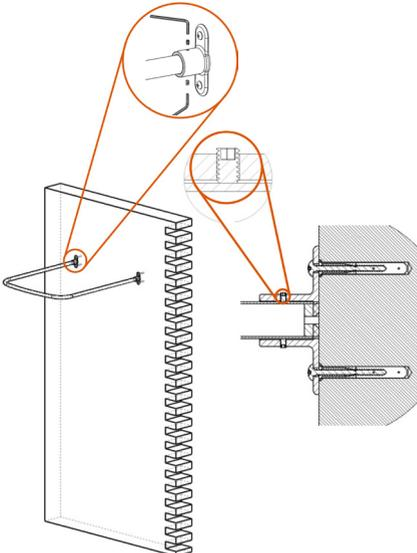
Die Halterung ist nun fest mit der Wand verschraubt und die Stange für den Duschvorhang kann eingesetzt werden. Mit den mitgelieferten Inbusschrauben fixieren Sie die Halterung mit der Stange.
