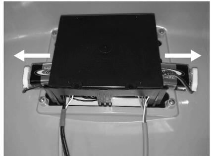
Abb. 15: Blockbatterien für die Notstromfunktion
