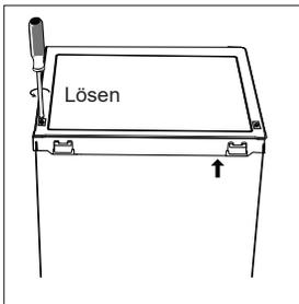
**Schritt 1:** Entfernen Sie die beiden Schrauben auf der Rückseite der oberen Abdeckung.
