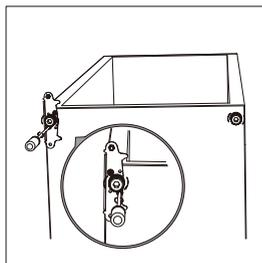
**Schritt 10:** Bringen Sie die Halterung mit dem unteren Scharnierstift wieder an. Bringen Sie beide höhenverstellbaren Füße wieder an.
