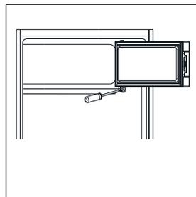
**Schritt 4:** Schrauben Sie das untere Scharnier der Gefriertür ab, nehmen Sie die Tür heraus und legen Sie sie auf eine weiche Unterlage, um Kratzer zu vermeiden.
