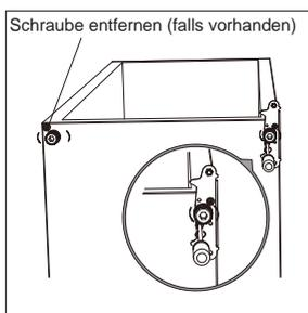
**Schritt 8:** Schrauben Sie das untere Scharnier ab. Dann die höhenverstellbaren FüÙe auf beiden Seiten entfernen.
