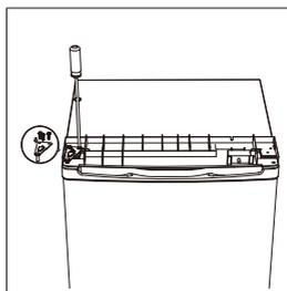
**Schritt 11:** Setzen Sie die Tür wieder auf. Vergewissern Sie sich, dass die Tür horizontal und vertikal ausgerichtet ist, so dass die Dichtungen auf allen Seiten geschlossen sind, bevor Sie das obere Scharnier endgültig festziehen.
