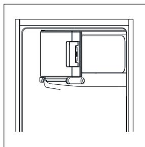
**Schritt 7:** Drehen Sie die Gefrierschranktür, setzen Sie das Scharnier auf die linke Seite und befestigen Sie die Tür mit dem Halter.
