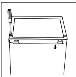
**Schritt 12:** Bringen Sie die obere Abdeckung an und befestigen Sie sie mit den beiden Schrauben auf der Rückseite.
