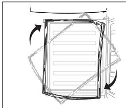
**Schritt 13:** Nehmen Sie die Dichtungen der Kühl- und Gefrierschranktüren ab, drehen Sie sie und bringen Sie sie wieder an.
