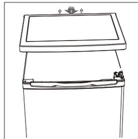
**Schritt 2:** Nehmen Sie die obere Abdeckung ab und legen Sie sie beiseite.
