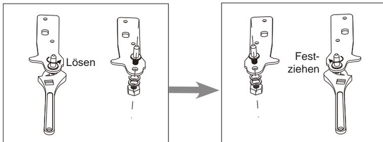
**Schritt 9:** Schrauben Sie den unteren Scharnierstift ab und entfernen Sie ihn, drehen Sie die Halterung um und setzen Sie sie wieder ein.
