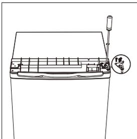
**Schritt 3:** Schrauben Sie das obere Scharnier ab, nehmen Sie die Tür heraus und legen Sie sie auf eine weiche Unterlage, um Kratzer zu vermeiden.
