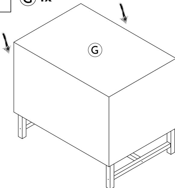
(DE) NACH REGEN ABDECKUNG ABNEHMEN UND TISCH LÜFTEN, DAMIT SCHIMMELBILDUNG AM HOLZ DURCH BODENFEUCHTIGKEIT VERMIEDEN WIRD!
