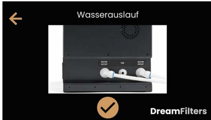
Überprüfen Sie den korrekten Anschluss des Wasserablaufs von der Maschine und bestätigen Sie ihn, um mit dem nächsten Schritt fortzufahren.
