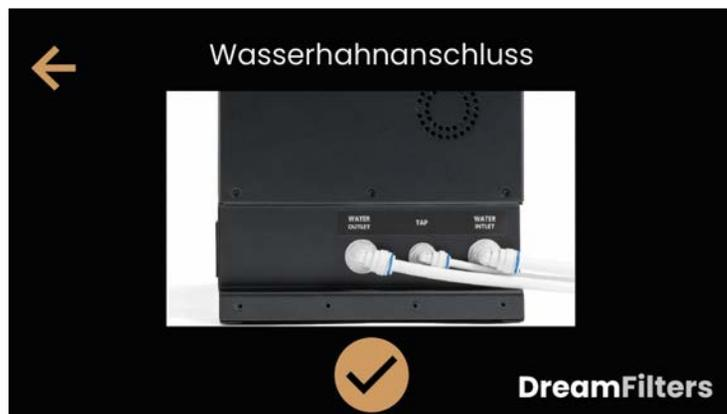
Überprüfen Sie den korrekten Anschluss des Edelstahlauslaufs und bestätigen Sie ihn, um mit dem nächsten Schritt fortzufahren.
