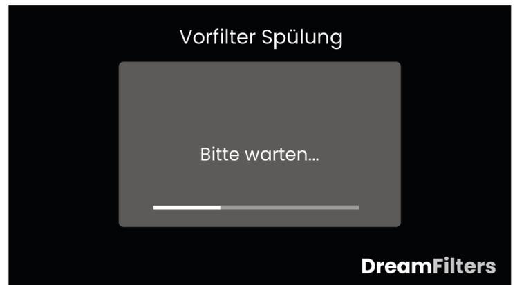
Das System wird mit Wasser gefüllt und alle Komponenten werden vorgespült. Der gesamte Vorgang des Vorspülens und Vorbereitens für die Reinwasserproduktion dauert 3 Minuten.
