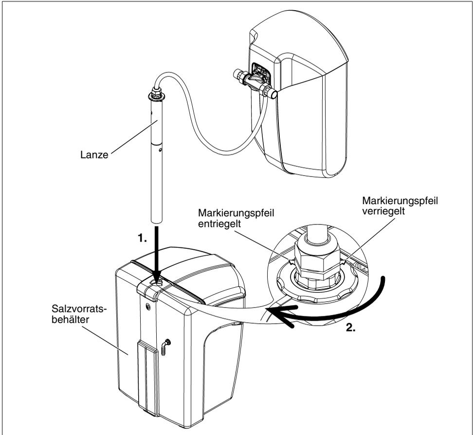
Abb. 9: Verbinden der Enthärtungsanlage mit dem Salzvorratsbehälter
