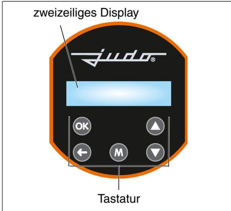
Abb. 11: Bedienfeld der Enthärtungsanlage
