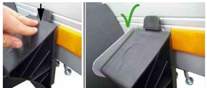
Um den Unterlegkeil in der Halterung zu befestigen, schieben Sie den Unterlegkeil von oben nach unten, bis er einrastet, in die Halterung ein.
