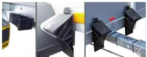
Beim Anbau der Keilhalterung ist zu Beachten, dass im Bereich der Verrasterungsnase genug Freiraum nach hinten, z. B. zur Bordwand, besteht, damit ein Entriegeln des Keiles aus der Halterung gegeben ist.
