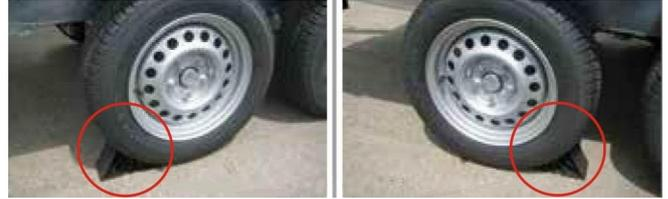
Schieben Sie deshalb nach dem Abkuppeln ihres Anhängers umgehend die Unterlegkeile, vollflächig auf einem standfesten Untergrund aufliegend, rechts und links unter die Räder.
