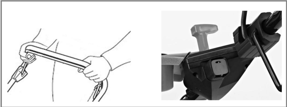
**Handstart.** Zum Starten des Gerätes ziehen Sie den Motor-Schalthebel an und halten Sie ihn angezogen. Ziehen Sie den Startseilzug langsam an, bis Sie Widerstand verspüren. Ziehen Sie schnell und kräftig am Startseilzug. Nach dem Starten des Motors lassen Sie den Startseilzug nicht los, sondern lassen Sie ihn vorsichtig in seine Ausgangsposition zurücklaufen. Falls der Motor beim ersten Mal nicht anspringt, wiederholen Sie den Vorgang.
