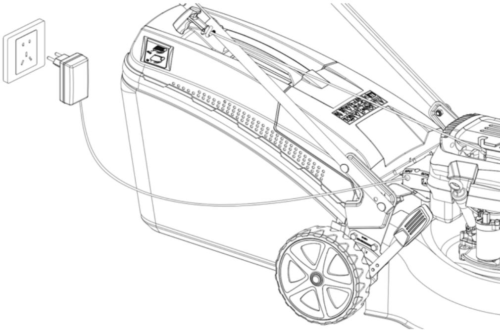
Verbinden Sie das Kabel des Ladegerätes mit dem Akku. Schliessen Sie das Ladegerät an die Steckdose an. Je nachdem wie oft der Rasenmäher angelassen wird, muss er alle 1-2 Monate aufgeladen werden.
