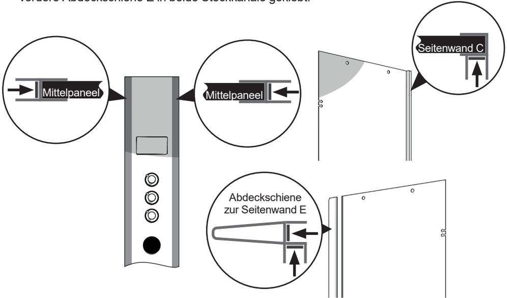
Die H-Dichtungen CE2 werden an alle schmalen Rückteile und an die vordere und hintere Seitenwand jeweils oben und unten aufgesteckt.
