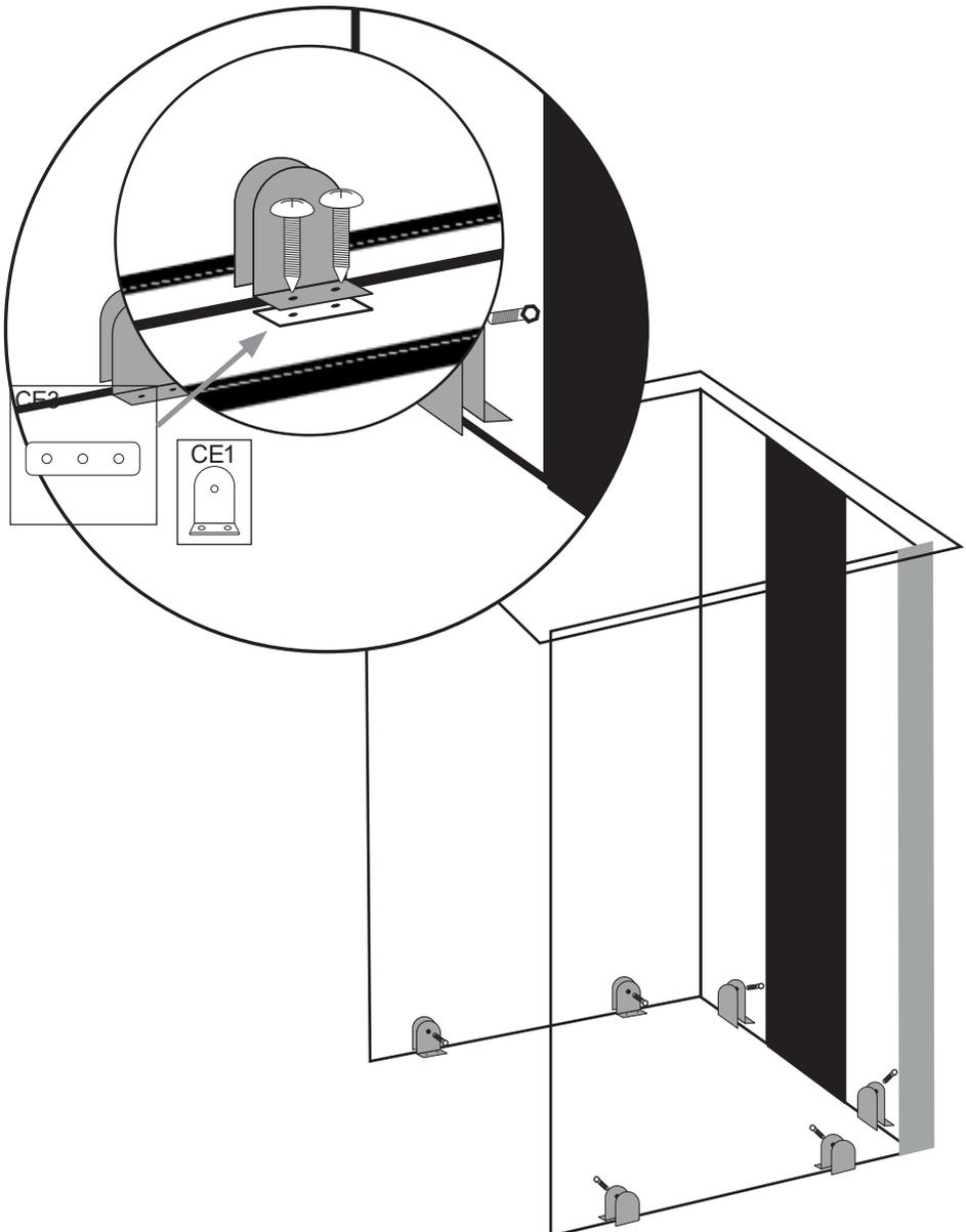
Sind die Winkel montiert setzen sie die gesamte Duschkabine auf den Wannenrand. Die Abdeckschiene der vorderen Seitenwand E sollte mit der äußeren rechten bzw. linken Wannenkante abschließen. Die Seitenwände C und E sowie die Rückwand D richten sie parallel zu den Wannenkante aus.
