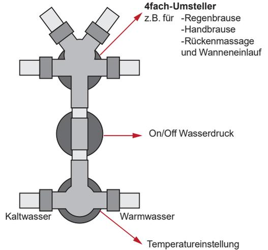
Verbinden Sie nun die Schläuche für die einzelnen Funktionen am Vierfachverteiler oben an der Armatur. Oben beginnend und dann im Uhrzeigersinn werden die Schläuche in der folgenden Reihenfolge angeschlossen. Erst die Regendusche, dann die Rückenmassage, dann der Wanneneinlauf und zuletzt die Handbrause. Die Panzerschläuche für die Wasserversorgung der Dusche kommen unten an den Zweifachanschluss, links an den blauen Punkt das Kaltwasser und rechts an den roten Punkt das Warmwasser.
