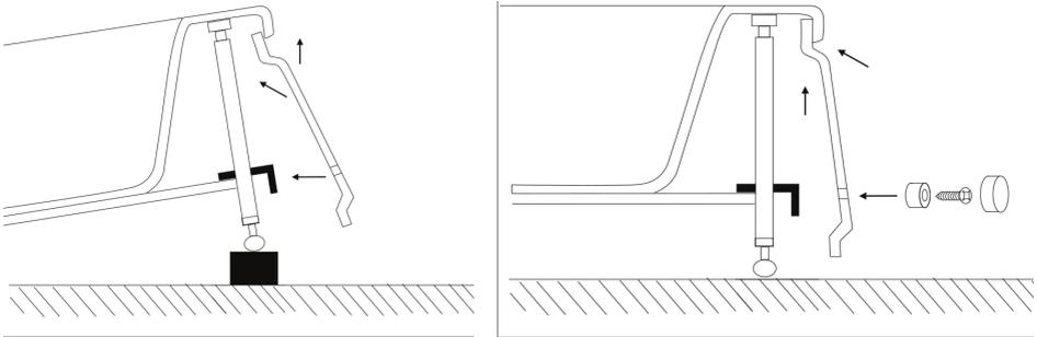
Dazu einfach die Wanne leicht ankippen und erhöhen um die Seitenteile unter zu klicken, nun nur noch mit den selbstschneidenden Schrauben befestigen und die Abdeckkappe auf die Schraube setzen.
