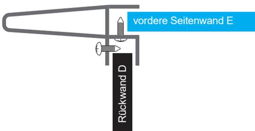
Die verbliebene offene Seite der Rückwand D schieben sie jetzt in die noch freie Steckschiene an der Abdeckleiste welche sie soeben mit der vorderen Seitenwand E verbunden haben. Auch hier werden die Teile von hinten an den vorgesehenen Stellen mit den Blechschrauben G2 miteinander verbunden.
