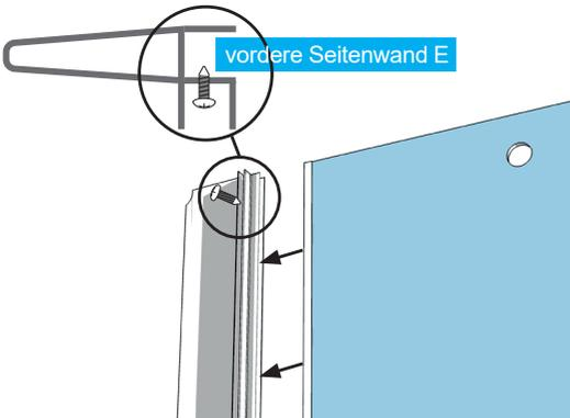
Die vordere Seitenwand E wird nun in die Abdeckschiene eingeschoben und mittels der 4 Blechschrauben G2 mit ihr fest verbunden. Die Schrauben werden in der noch offenen Steckschiene verschraubt.
