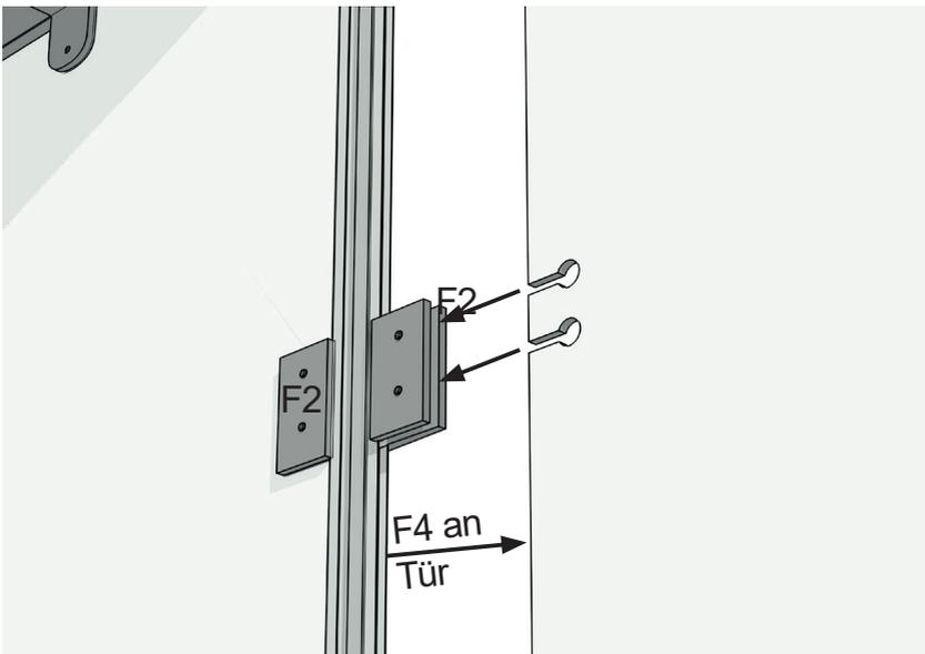
Jetzt werden die beiden Türen in die offene Seite der Scharniere geschoben und ebenfalls verschraubt.
