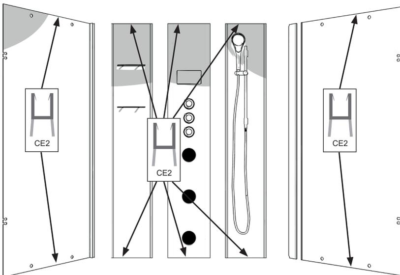
Jetzt können die schmalen Rückwandteile rechts und links in das Mittelpaneel eingesteckt werden. Bitte beachten sie, dass sowohl bei der Links- als auch bei der Rechtsvariante die Rückwand mit der Handbrause rechts und die Rückwand mit den Glasregalen links an das Mittelpaneel angesteckt wird. Alle drei Teile werden von hinten mit den Blechschrauben G2 an den vorgesehenen Löchern miteinander verschraubt.
