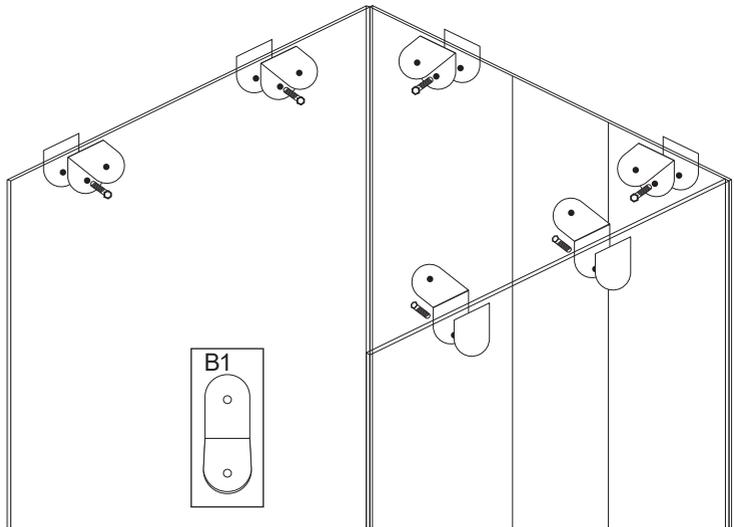
Setzen sie jetzt den Deckel B auf die Kabine auf und verschrauben ihn mit den Winkeln, die sie an den Seiten- und Rückwänden angebracht haben.
