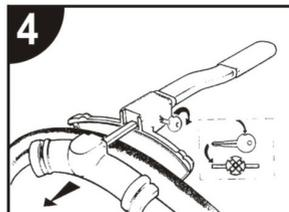
4. Öffnen: Drehen Sie den Schlüssel im Schloss. Der vordere Teil wird sich von selbst öffnen. Danach entfernen Sie das Schloss vom Lenkrad.
