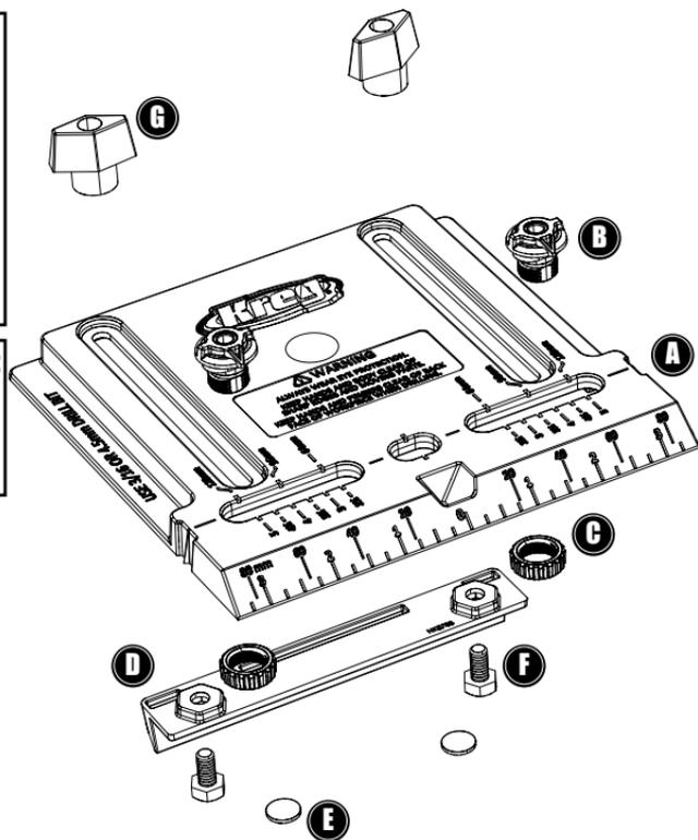
Retire el papel protector de las almohadillas antideslizantes e insértelas en las ranuras circulares de la guía de borde. Ubique la guía de borde entre las escalas de pulgadas en la parte inferior de la base. Inserte los pernos de cabeza hexagonal en los orificios de la parte inferior de las ranuras hexagonales y enrosque en las perillas en T desde la parte superior de la base.
