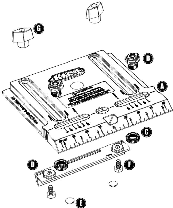
Retirez les tampons antidérapants de la pellicule protectrice et insérez-les dans les alvéoles circulaires du guide de rebord. Placez le guide de rebord sur la partie inférieure de la base, entre les échelles en pouces et en millimètres. Insérez les boulons à tête hexagonale dans les alvéoles hexagonales par le dessous de la base et vissez les boutons en T sur les boulons à tête hexagonale par le dessus.
