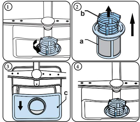
Drehen Sie die Filterkombination zum Entfernen und Reinigen gegen den Uhrzeigersinn und nehmen Sie sie durch Anheben nach oben heraus (1). Ziehen Sie den Grobfilter aus dem Mikrofilter heraus (2). Ziehen Sie dann den Metallfilter (3) heraus und entfernen Sie ihn. Spülen Sie den Filter mit viel Wasser ab, bis er frei von Rückständen ist. Bauen Sie die Filter wieder zusammen. Setzen Sie den Filtereinsatz wieder ein und arretieren Sie ihn im Uhrzeigersinn (4).
