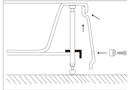
Dazu einfach die Wanne leicht ankippen und erhöhen um die Seitenteile unter zu klicken, nun nur noch verschrauben und die Abdeckkappe auf die Schraube setzen.
