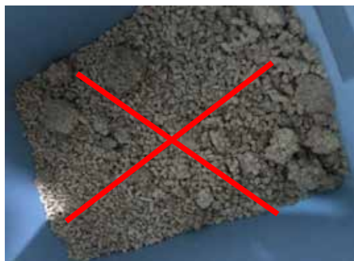
Agglomération de granulés de mauvaise qualité
