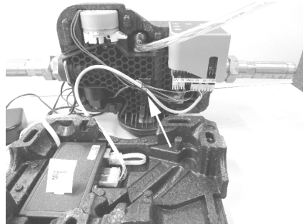
Abb. 8: Verbindungskabel in den Kabelbinder einsetzen
