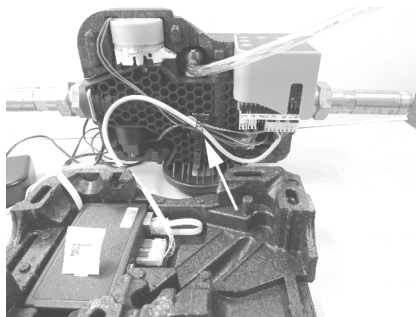
Fig. 9: Enfoncer le câble de connexion dans l'attache- câbles
