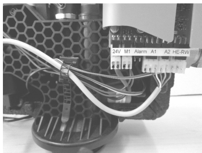
Afb. 6: Sluit de stekkers A1 en A2 aan op de elektronische regeling
