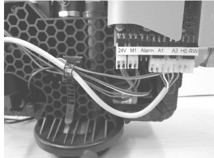
Abb. 6: Stecker A1 und A2 an Steuerung anschließen
