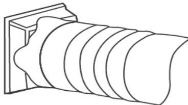
**Schritt 2:** Verbinde das andere Ende vom Abluftschlauch mit dem Adapter (Fenster)
