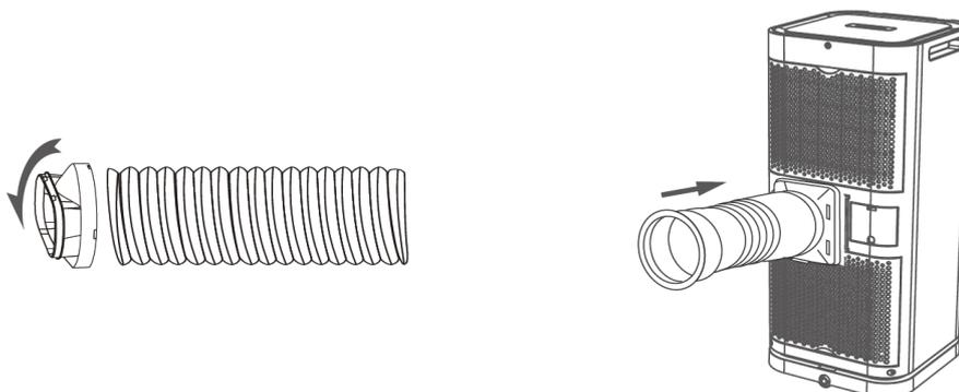
**Schritt 4:** Pass die Länge des flexiblen Abluftschlauches an, um Knickstellen zu vermeiden. Öffne das Fenster einen Spalt und klemm den Abluftschlauch mit Hilfe des Verschlusses ein. Platzieren das Produkt in der Nähe einer Steckdose
