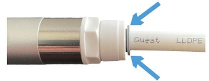
b) Um den Schlauch vom Modul zu trennen, muss zuerst der Sicherheitsring entfernt werden. Danach den grauen Ring – wie auf dem nebenstehenden Bild gezeigt – **gleichmäßig eindrücken** und den Schlauch herausziehen. Ohne gleichmäßiges Eindrücken des grauen Rings lässt sich der Schlauch nicht entfernen.
