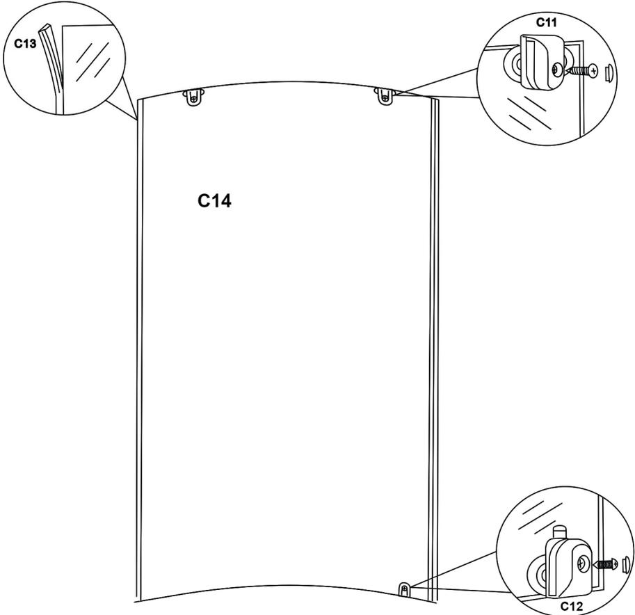
Die Grafik zeigt die Vorbereitung der Tür, das ist völlig unkompliziert. Zu beachten gibt es lediglich das die Rolle C12 (mit Druckknopf) nach unten gehören, die anderen C11 nach oben. Die Türdichtung C13 muss so aufgesteckt werden, dass diese nach außen hin zeigt.
