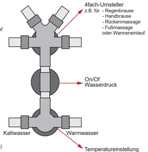
Verbinden Sie nun die Schläuche für die einzelnen Funktionen am Vierfachverteiler oben an der Armatur. Oben beginnend und dann im Uhrzeigersinn werden die Schläuche in der folgenden Reihenfolge angeschlossen. Erst die Regendusche, dann die Rückenmassage, dann der Wanneneinlauf und zuletzt die Handbrause. Die Panzerschläuche für die Wasserversorgung der Dusche kommen unten an den Zweifachanschluss, links an den blauen Punkt das Kaltwasser und rechts an den roten Punkt das Warmwasser.
