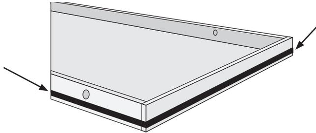
Stellen Sie nun, zuerst die linke Rückwand, dann das Paneel und dann die rechte Rückwand auf die Wanne. Alles erst mal locker mit 1-2 Schrauben sichern um danach die Baugruppen in den Langlöchern auszurichten und vollständig zu verschrauben.
