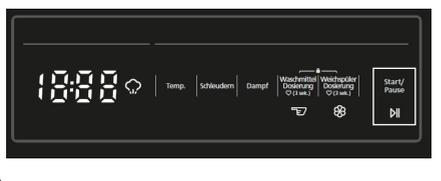
Durch Drücken der Start/Pause-Taste können Sie ein ausgewähltes Programm starten oder ein bereits laufendes Programm anhalten. Falls Sie Ihre Maschine in den Bereitschaftsmodus schalten, blinkt die Start/Pause-LED am Display.
