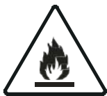
Attenzione: pericolo di incendio
