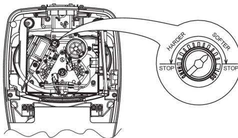
**i** Ab Werk ist die Stellschraube des Verschneideventils leicht geöffnet.
