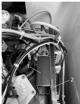
Abb. 13: Connectivity-Modul in Halterung
