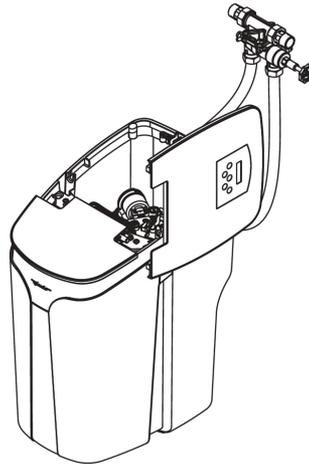
Abb. 8: Deckel nach Abnahme am Gehäuse einhängen
