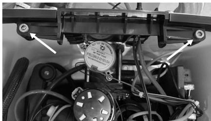
Abb. 9: Schrauben des schwarzen Einsatzes lösen
