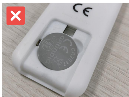
Mauvaise façon de placer la pile
