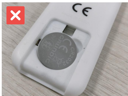
Forma incorrecta de colocar la pila
