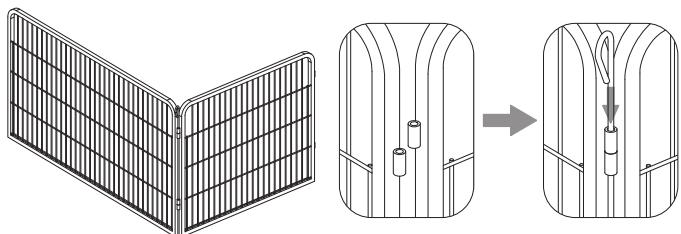
Placez deux éléments côté à côté. Tenez les trous des charnières alignés les uns au-dessus des autres. Introduisez les barres de liaison dans les trous.
