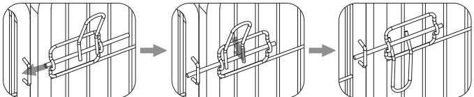
Fermez la porte en faisant coulisser la barre de la poignée dans le trou de la fermeture.
