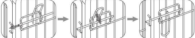
Verriegeln Sie die Schwingtür, indem Sie den Riegel am Griff in die Halterung schieben.
