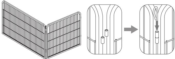
Stellen Sie zwei Elemente an den Rahmen zusammen. Halten Sie die Bohrungen der Scharniere bündig übereinander. Stecken Sie einen Ankerhaken durch die Scharniere.
