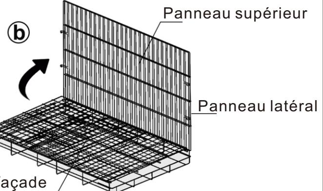
Déverrouiller le dispositif de verrouillage situé sur le côté de la caisse. Saisissez n'importe quel fil du panneau supérieur et tournez-le comme la page d'un livre, puis saisissez les panneaux supérieur et latéral et tirez vers le hautPanneau supérieur
