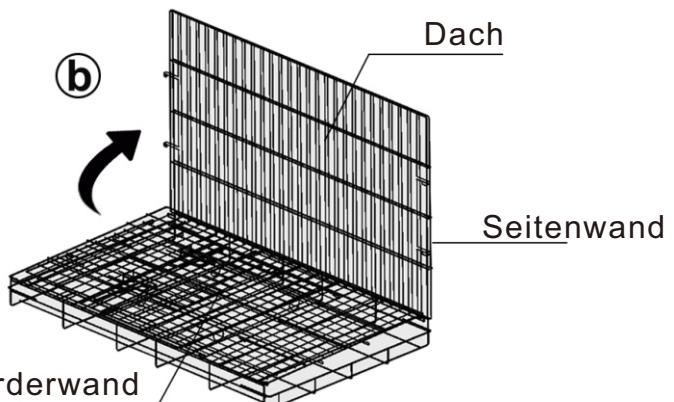
Lösen Sie die Sperre an der Seite der Kiste. Fassen Sie einen Draht am Dach und falten Sie ihn um, ziehen Sie dann das Dach und Seitenwand zusammen und ziehen Sie sie nach oben.
