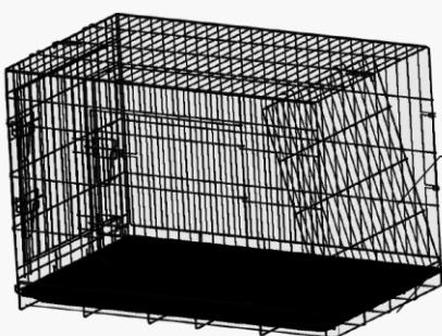
Mettez votre main dans la cage. Tirez le panneau de la porte de la cage et le panneau latéral vers l'extérieur respectivement jusqu'à ce qu'ils soient installés dans les clips du filet avant et du filet arrière, et répétez l'opération à l'autre extrémité.
