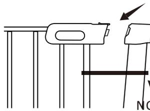
La brecha de la puerta NO es un defecto, se disminuirá a 0,2 cm después de la instalación.
