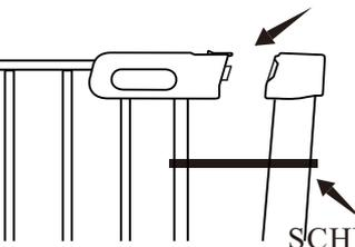
Der Türspalt ist KEIN Defekt! Nach der Installation wird er auf 0,2 cm verkürzt sein
