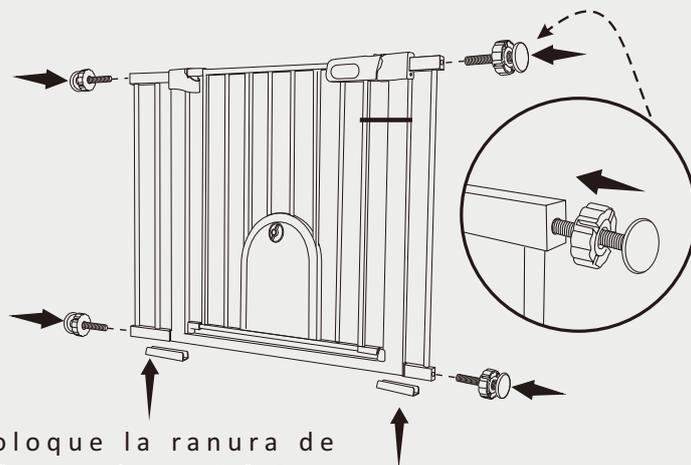
Coloque la ranura de refuerzo en la parte inferior.
