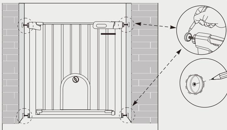
Strisce adesive quando si utilizza l'installazione a pressione. Rimuovere due lati delle strisce adesive, incollare 4 scodellini a muro. Poi utilizzare gli scodellini a muro per coprire gli alberini.
