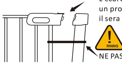
L'écart entre les portes n'est PAS un problème ! Après l'installation, il sera réduit à 0,2 cm.
