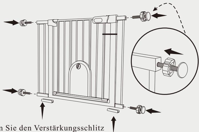
Fügen Sie den Verstärkungsschlitz an der Unterseite hinzu
