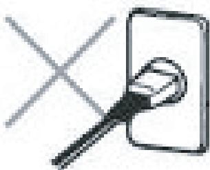
Stellen Sie sicher, dass Sie den Stecker korrekt einstecken. Wenn der Stecker nicht vollständig eingesteckt ist, kann dies zu einem Stromschlag, Hitzeentwicklung, Feuer usw. führen.
