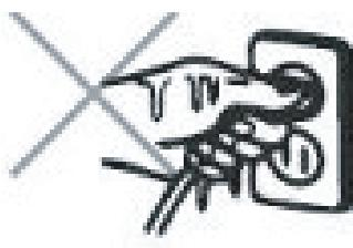
Beim Herausziehen des Steckers ziehen Sie nicht direkt am Stromkabel, sondern am Stecker, da dies einen Kurzschluss und einen Brand verursachen könnte.
